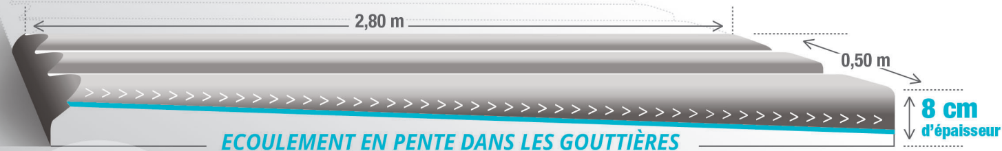
Tapis - Vue de dessous Sa forme évidée joue un rôle d'amortisseur.
